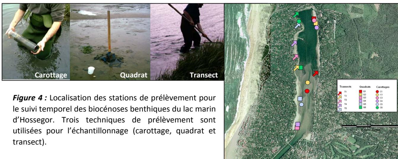
**Figure 4 :** Localisation des stations de prélèvement pour le suivi temporel des biocénoses benthiques du lac marin d’Hossegor. Trois techniques de prélèvement sont utilisées pour l’échantillonnage (carottage, quadrat et transect).
